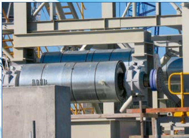
Polia de correia transportadora com anéis de fixação, além de um anel de contração fixando o acoplamento de flanges do acionamento.
